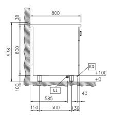
Electrical inlet (power) Equipotential screw
